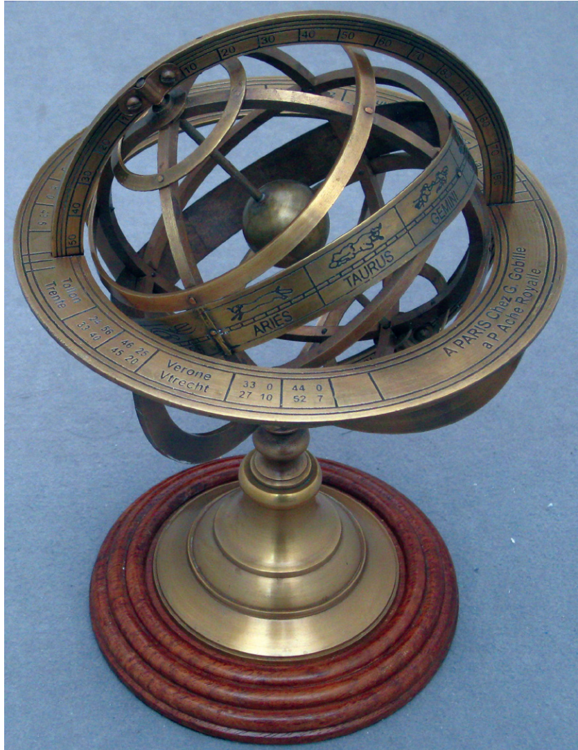
Figuur 1 Met een armillarium kan de positie van een hemellichaam aan de hemel worden gemeten volgens verschillende coördinatenstelsels.
