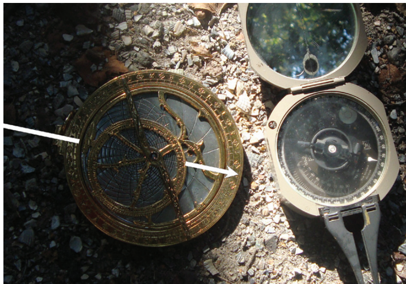
Figuur 5 Bepaling van het noorden met een astrolabium dat half in de schaduw ligt: de witte pijl geeft de berekende richting van het noorden aan (links). Rechts een magnetisch kompas dat het noorden aanwijst.
