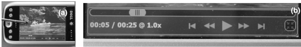
Abbildung 1: (a) Einblendung der Standard-Bedienelemente bei Berühren des Bildschirms, (b) Slider zur positionsbasierten Navigation (oben), Abspieldauer, Gesamtlänge und Abspielgeschwindigkeit (links unten), Abspielbuttons (Mitte/rechts) und Icon zum Verlassen des Vollbildmodus, Laden neuer Files, etc. (rechts unten).
