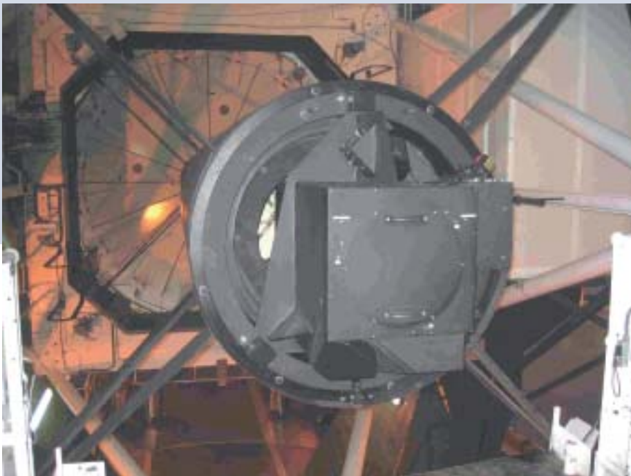
El telescopio para el lanzamiento del haz de láser (delante) que se muestra montado en el espejo secundario del WHT con el espejo primario (cubierto) en el fondo.
