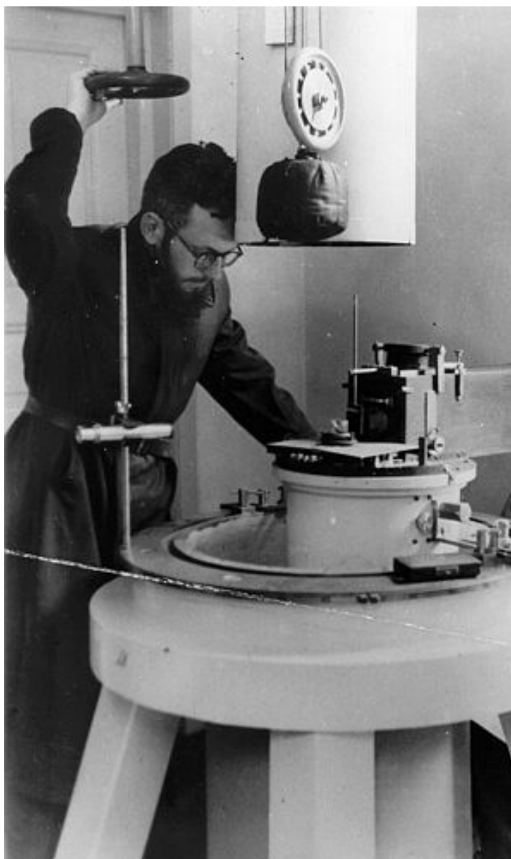
Figuur 4: C. de Jager bij de spectroheliograaf, 1944. De heliograafbuis kantelde om een draaipunt beneden in de kelder, zodat de ingangsspleet het zonsbeeld aftast. De Jager, toen nog zwartharig en met andere studenten ondergedoken op Zonneburg, verdraait de tweede coelostaatspiegel in azimut. Het touw met katrol en zandzak diende voor de elevatie-instelling met een worm en wormwiel die, met Minnaertse handbediening, te zien zijn in Figuur 3.
