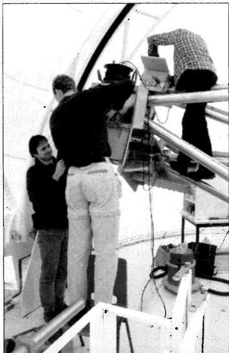
Drie medewerkers van het DOT team bezig met de bekabeling van de digitale camera's. Je ziet de top van de telescoop in parkeerstand onder de gesloten koepeltent. De beelden gaan door optische fibers naar een Zweeds gebouw 100 meter verderop. Maart 2003.
