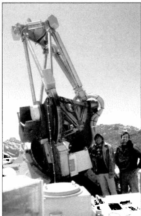
De DOT van dichtbij, met Felix Bettonvil en Pit Sütterlin. De uiterst zware structuur is nodig om zeker te zijn dat de telescoop ook in heel harde wind niet wiebelt. Op de voorgrond de spiegeldeksel. Door de slangen wordt lucht afgezogen om luchtwervelingen te voorkomen.
